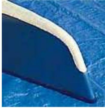
Abbildung 6.13.: Sogenannte *Skid-Plates* schützen den Bug und das Heck vor starker Abnutzung, sind aber kein Allheilmittel. Im Touralltag überwiegen die Nachteile. Courtesy of We-no-nah, ©We-no-nah
